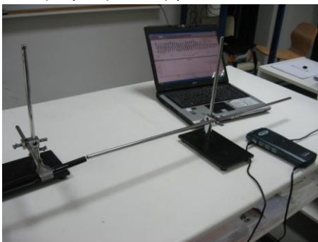
Σχήμα 7: Διάταξη στάσιμου κύματος σε μεταλλική ράβδο με σφιγκτήρα στο μέσον (Un. Texas-Arlington 2005)
